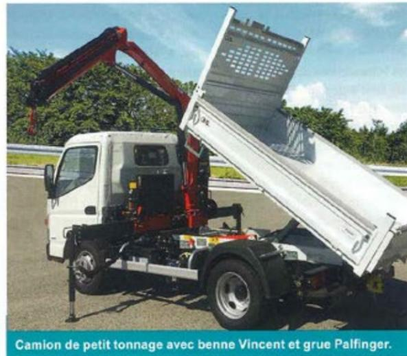
Camion de petit tonnage avec benne Vincent et grue Palfinger.
