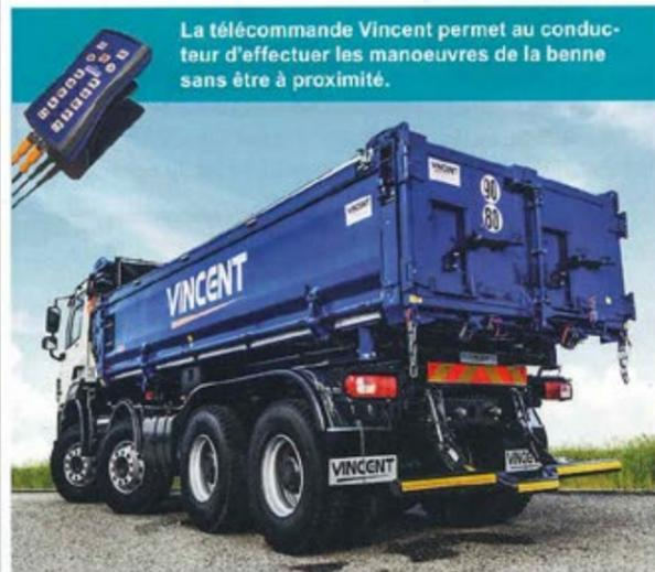
La télécommande Vincent permet au conducteur d'effectuer les manoeuvres de la benne sans être à proximité.
