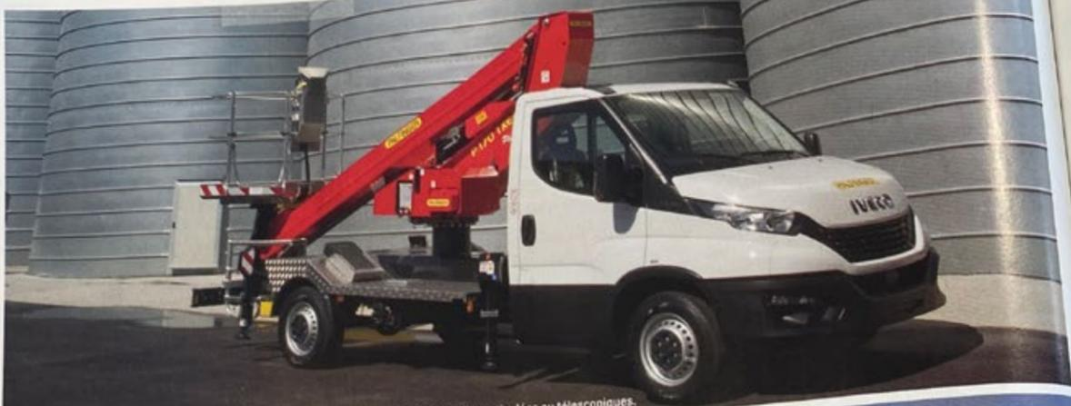
Palfinger France propose pour les véhicules de 3,5 t à 7,5 tonnes une gamme de nacelles articulées ou télescopiques.
