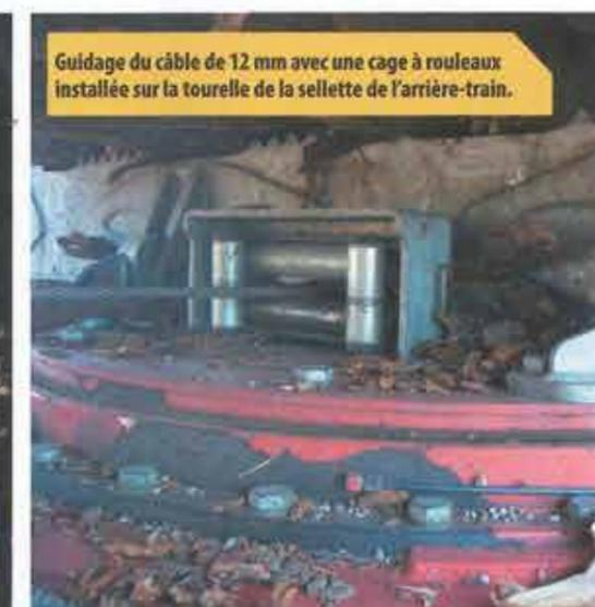
Guidage du câble de 12 mm avec une cage à rouleaux installée sur la tourelle de la sellette de l'arrière-train.
