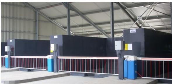
Les garde-corps permettent de sécuriser la zone de déchargement afin d'éviter toute chute dans la trémie. Portails coulissants, barrières relevables ou portails 2 vantaux... les équipements proposés sont étudiés pour apporter confort d'utilisation et sécurité maximale à l'utilisateur.
