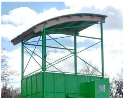
Afin d'éviter la dispersion de déchets légers et papiers sur le site, nous vous proposons une trémie enveloppante équipée d'un système anti-envol. Cette trémie est composée, dans sa partie supérieure, d'un bardage métallique ou d'une structure en tubes recouvertes de filets à mailles fines offrant une très faible résistance au vent.
