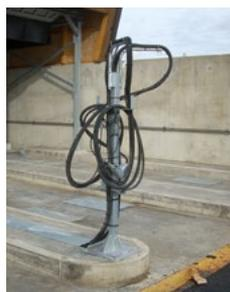
Des supports flexibles sont mis en place pour raccorder la semi-remorque à la centrale hydraulique.
